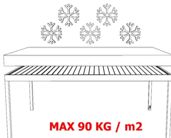
7. ábra - A zárt lamellákra megengedett legnagyobb hóterhelés
